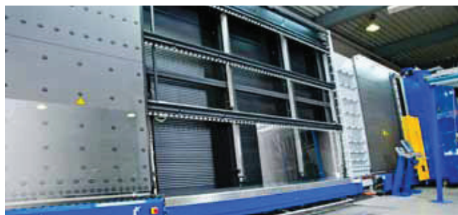
Die Rahmenaufsetz- und Visitierstation der neuen Isolierlinie
