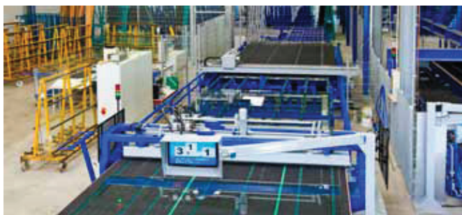
Die neue Schneid- und Brechlinie für Floatglas mit Kompaktlager
